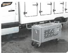
Gruppo remoto con innesto rapido. Remote refrigerating unit with fast coupling system.
